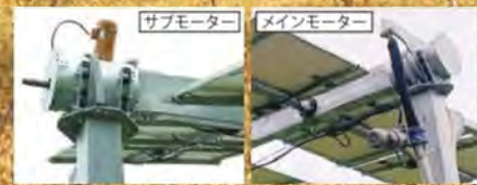
2種のモーターの組み合わせにより、太陽の3D(2軸)追尾を実現する。
